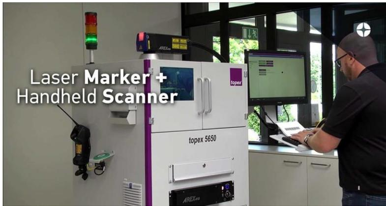
无论是在汽车制造商还是供应商，永久性部件打标在汽车行业中都发挥着重要作用。凭借 LM5650 激光标记系统，我们的合作伙伴 Topex 公司为德国一家领先的汽车制造商设计了一套定制的解决方案。该系统在一次操作中就能为温度、环境和机械影响等方面的特殊要求制作标签。来自 Datalogic 得利捷的集成光纤激光 AREX401 确保了出色的贴标和切割效果。
